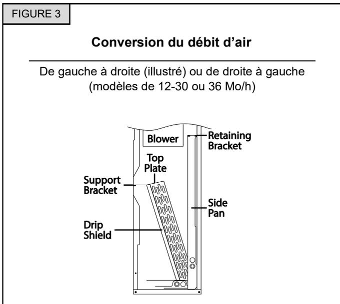
6. Retirer les vis maintenant le support du serpentin sur le côté gauche de la plaque supérieure. Repositionner le support du serpentin sur le côté droit de la plaque supérieure.
