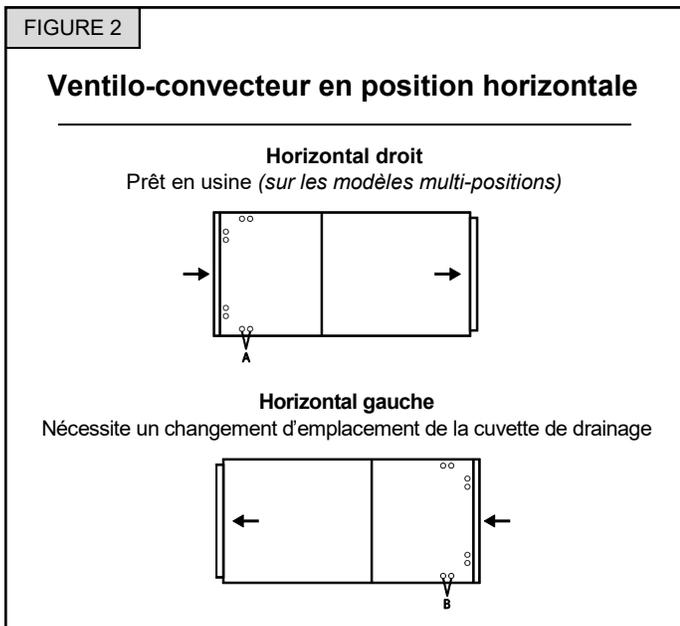
Les modèles indiqués à la Figure 3 sont expédiés avec une configuration horizontale à droite. Pour convertir en débit d'air horizontal gauche, procédez comme suit :
