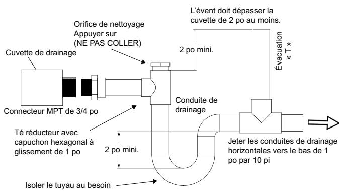
Acheminer la conduite de drainage de manière à ce qu'elle n'interfère pas avec l'accessibilité au serpentin, au système de traitement de l'air ou au filtre et qu'elle ne soit pas exposée au gel.
