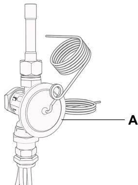
**REMARQUE:** Certains modèles sont équipés d'un vanne d'expansion thermique et ne nécessitent aucun changement d'orifice.
