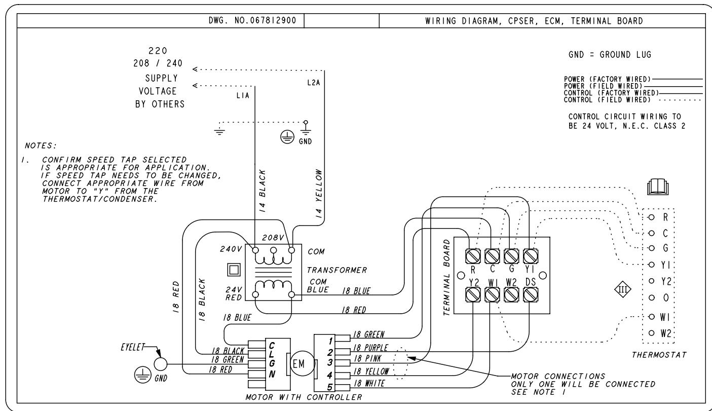
Réf. Pièce: 67844000 | SCHÉMA DE CÂBLAGE, ECM, CHAUFFAGE ÉLECTRIQUE
