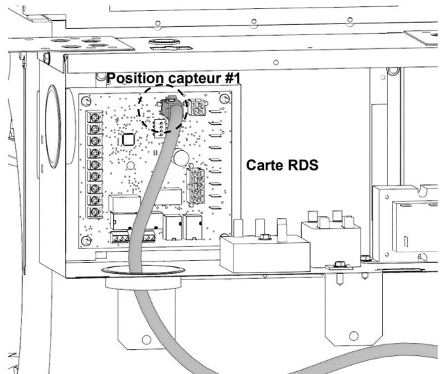
**REMARQUE** : Le ventilo-convecteur de la série F sera configuré en usine pour l'application ascendante avec le capteur de réfrigérant A2L (R-454B et R-32) positionné au bas du ventilo-convecteur comme illustré.
