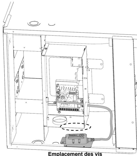
4. S'assurer que le câble du capteur et l'élément de détection sont orientés comme illustré.
