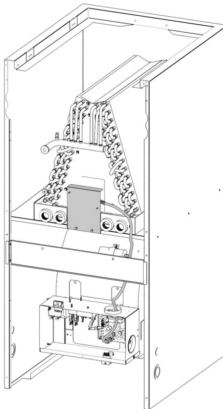
6. S'assurer que le capteur est monté de manière à ce que l'élément de détection soit face au serpentin et qu'il ne soit pas obstrué par les tubes du distributeur ou la TXV.
