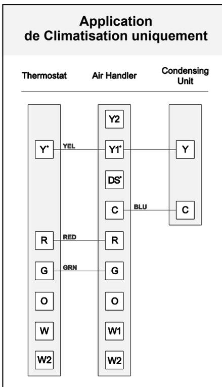
\* Pour les systèmes à forte électricité statique, cavaliers « Y1 » et « DS » au niveau du bornier du ventilo-convecteur
