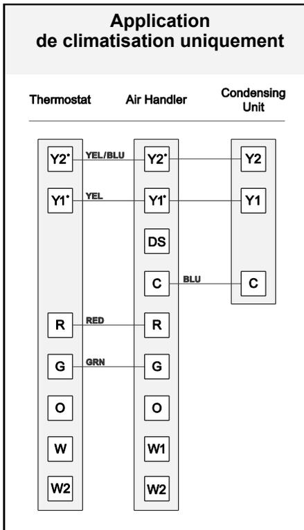
Pour un fonctionnement typique à 2 stages, déplacer la prise 3 (JAUNE) du moteur sur Y2 et la prise 2 (BRN) du moteur sur Y1.
