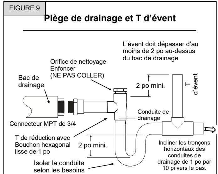
conduite. Testez l'écoulement de l'eau lorsque l'unité fonctionne. Un bac de drainage auxiliaire doit être installé sous l'unité et avoir une surface supérieure à celle du serpentin, comme spécifié par la plupart des codes du bâtiment locaux.
