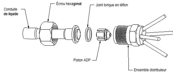
1. Desserrez l'écrou hexagonal situé sur la conduite de liquide et écartez-le de l'ensemble distributeur.
