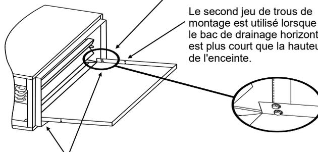
Le second jeu de trous de montage est utilisé lorsque le bac de drainage horizontal est plus court que la hauteur de l'enceinte.
